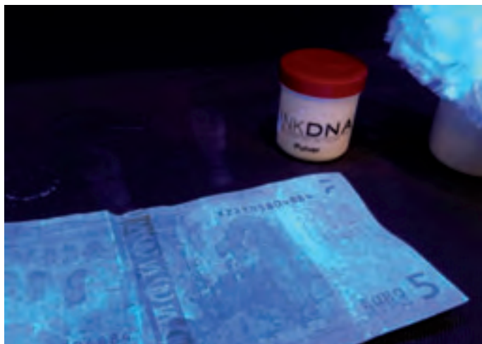
Ein mit LinkDNA Pulver bestaubter Geldschein unter UV Licht.
